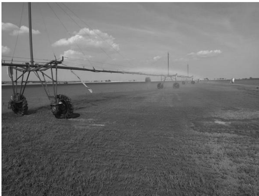
Рис. 3. Широкозахватная дождевальная машина «Дон-К», ФГБНУ РОСНИИПМ (г. Новочеркасск Ростовская область).
